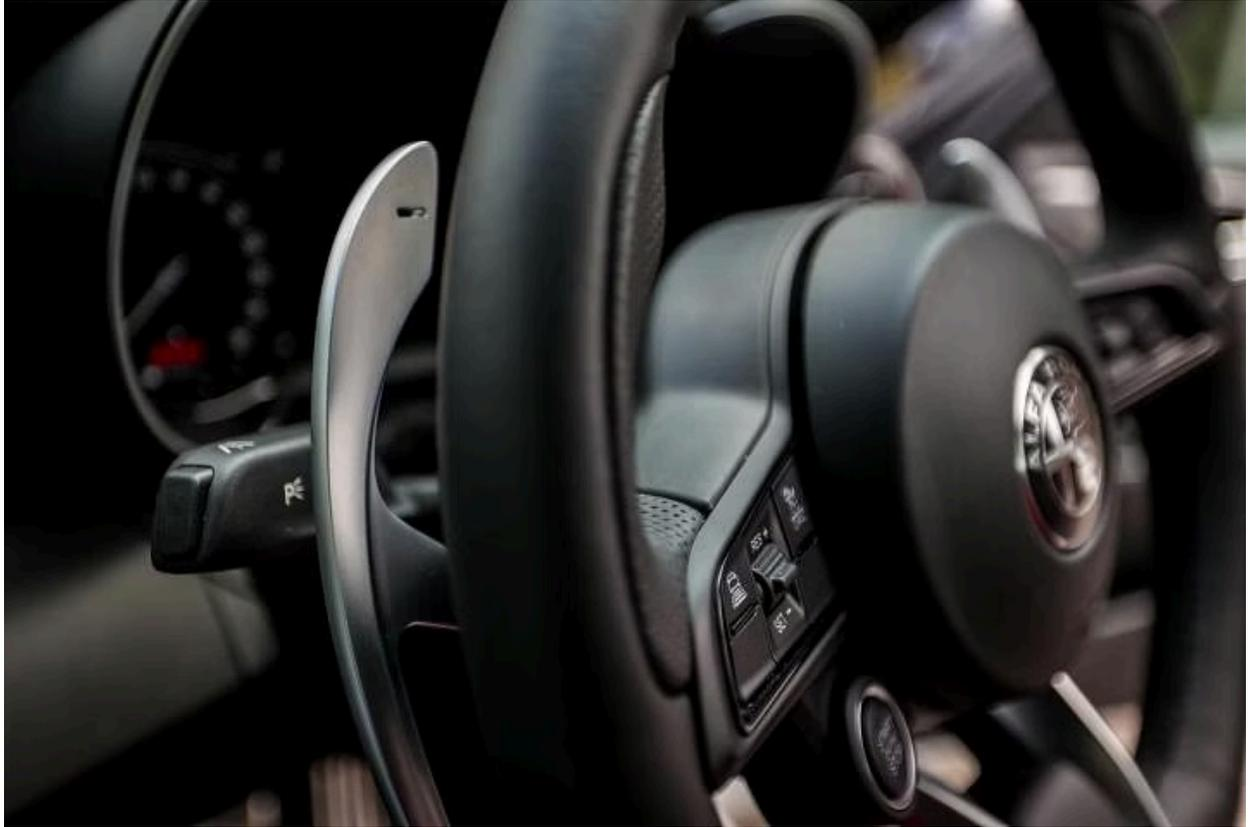
驾驶者能直接使用方向盘后方的换挡拨片控制挡次。
