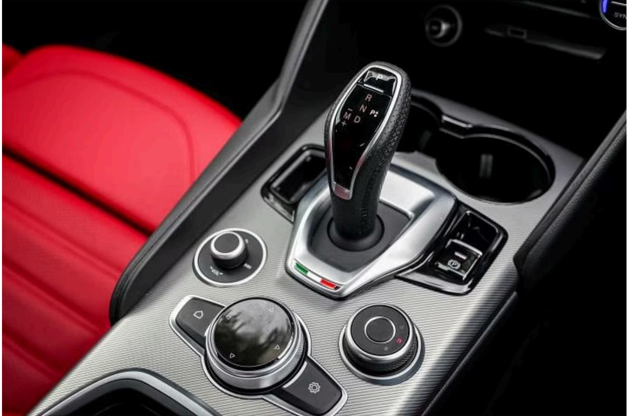
中央扶手箱前方是多功能控制旋钮、音量和媒体控制旋钮，以及驾驶模式旋钮。
